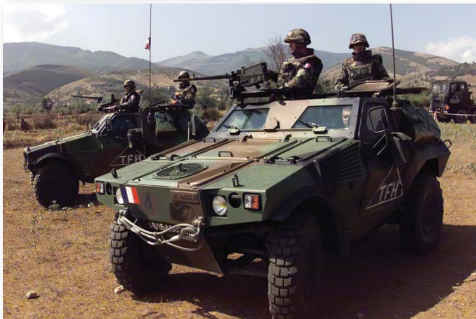
Употреба челика високе тврдоће 500 НВ омогућила је малу масу возила VBL
