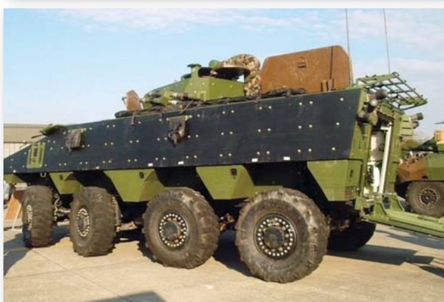
Борбено возило пешадије Dardo пример је комбинације легуре алуминијума и челика високе /ултрависоке тврдоће
